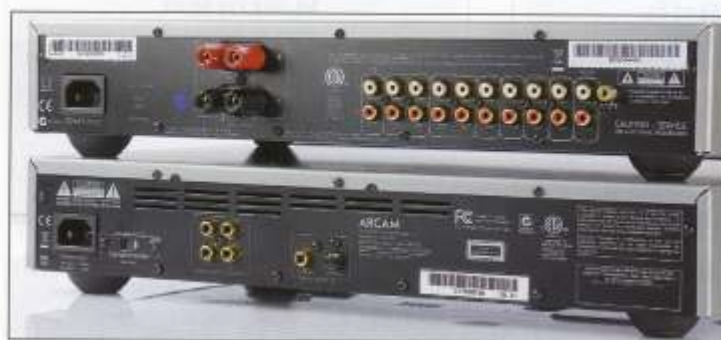
Zdublowane wyjścia w odtwarzaczu, wygodne zaciski głośnikowe, gniazda wejściowe w dwóch szeregach. Nie ma wątpliwości – to Arcam
