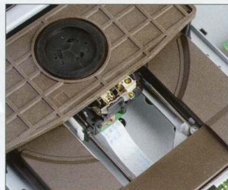
Mechanika z twardego plastiku zwanego Zylonem
