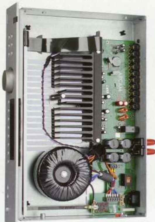
Największą część wzmacniacza zajmują transformator zasilający i masywny radiator
