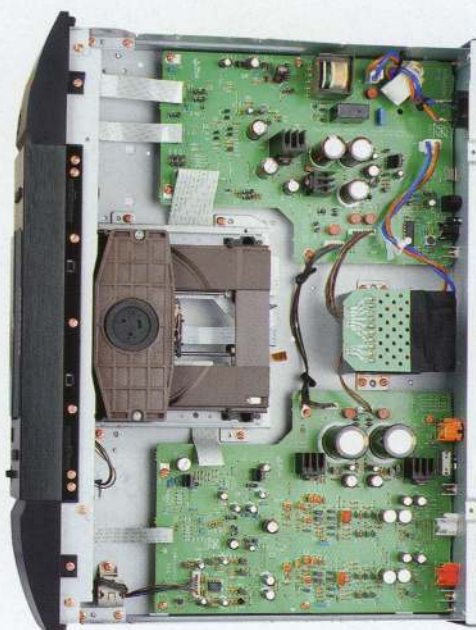
Cyfra na górze, na dole analog, pośrodku – napęd i transformator z rdzeniem EI
