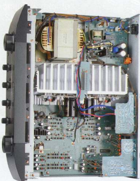
Masywny radiator pełni też funkcję ekranu, izolując transformator od układu elektronicznego
