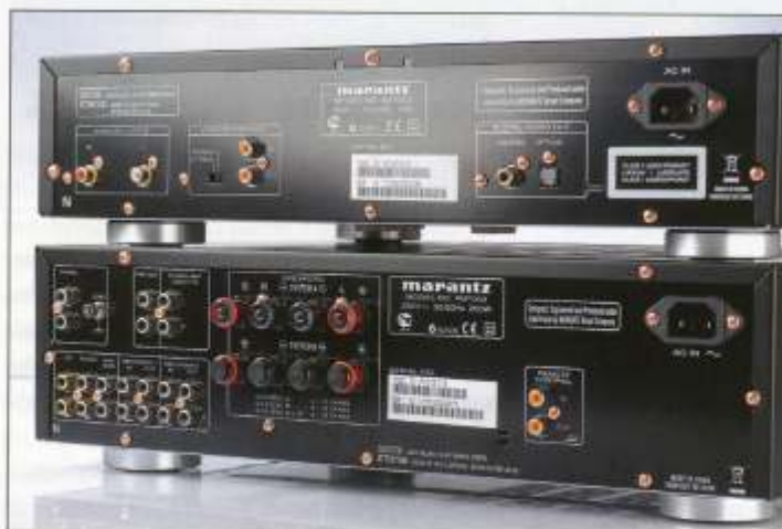
Podwójne gniazda głośnikowe są zatacane pokrętłem na przedniej ścianie. Tylko dlatego nie można podłączyć widełek?
