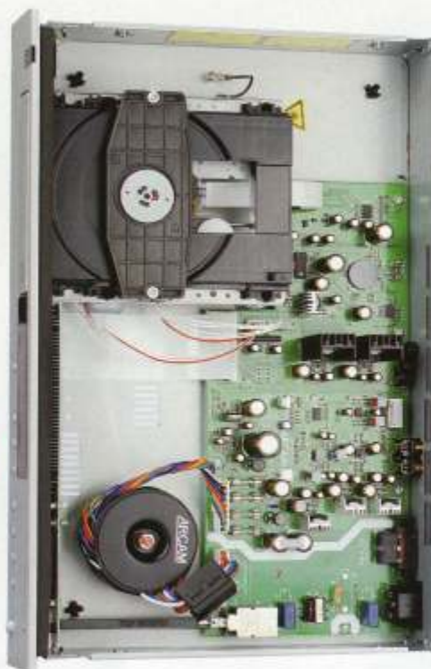
Na płycie drukowanej skorzystano z dobrodziejstw montażu przewlekanego i powierzchniowego
