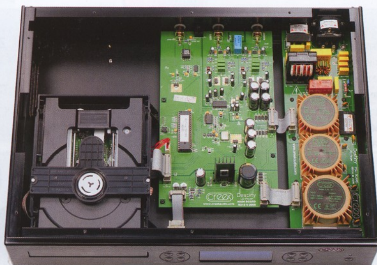
Wzmacniacz i odtwarzacz wyglądają podobnie jak poprzednicy. W odtwarzaczu zwraca uwagę rozbudowany zasilacz z trzema transformatorami i filtracją na wejściu
