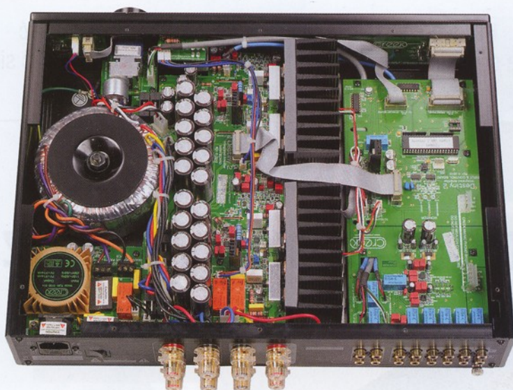
Wzmacniacz i odtwarzacz wyglądają podobnie jak poprzednicy. W odtwarzaczu zwraca uwagę rozbudowany zasilacz z trzema transformatorami i filtracją na wejściu
